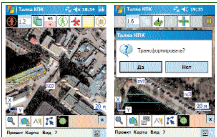
Рис. 7 Съемка вершин объекта, трансформация объекта по измерениям
