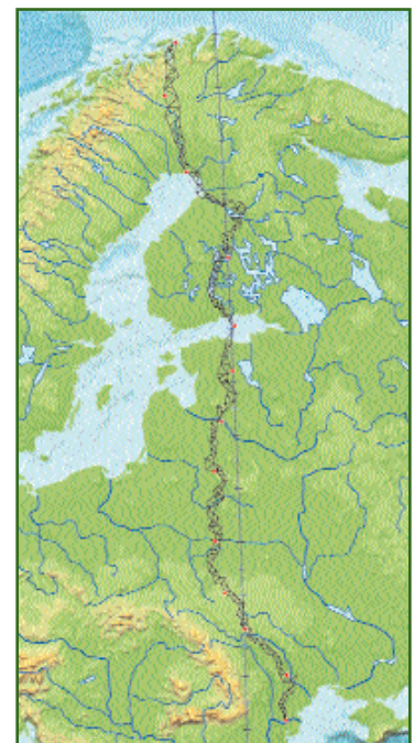
Рис. 2 Схема триангуляции «Дуги Струве», 1816–1855 гг.
